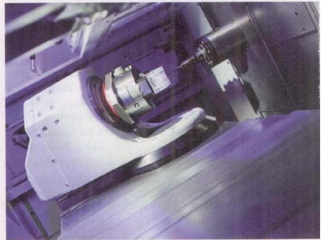
Bild 2: Herzstück des Transfersystems ist die B/C-Achse: Die C-Achse beschleunigt mit 1,4 g auf die maximale Drehzahl von 500 min -1 .
