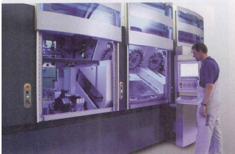
Bild 1: Das Transfersystem Multistep XT-200 besteht aus bis zu vier Modulen und bearbeitet Werkstücke einbaufertig.
