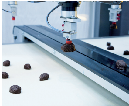
Das Greifersystem kann mehrere Produkte gleichzeitig aufnehmen. (Foto: Cama)
