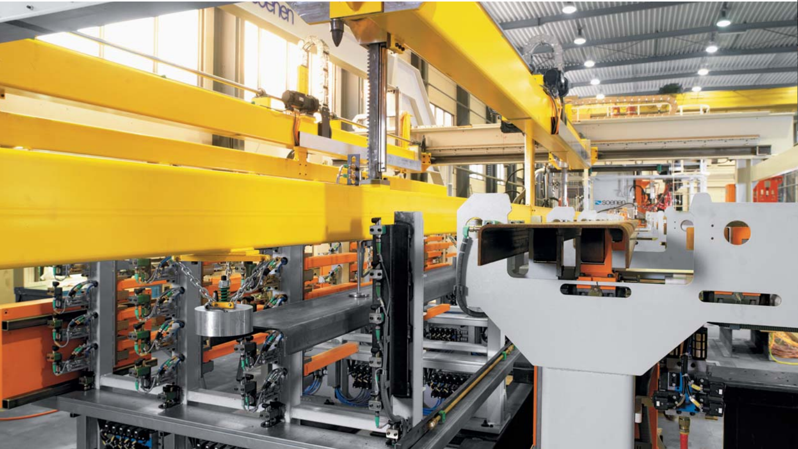
▲ In dieser Maschine werden Löcher in die Trägerprofile für die Fahrwerke von Nutzfahrzeugen gebohrt.
