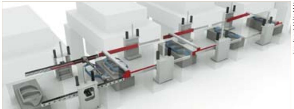
(l.) «roboBeam», das modulare System. (r.) Schematischer Aufbau einer kompletten Pressenlinie.
