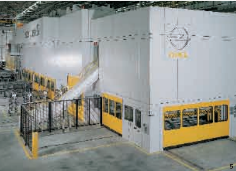
4 _ Schema eines Schuler Compact Crossbar Transferpressen-Systems bei Ford in Saarlouis. 5 _ Eine der ersten Schuler Compact Crossbar Transferpressen-Systeme ging an Opel in Antwerpen.
