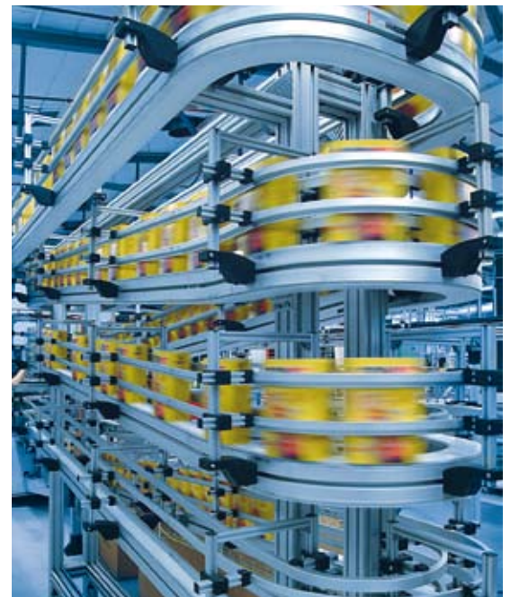
Transport et enregistrement dans un seul système. A vitesses réglées, le système VarioFlow s'adapte aux variations de production des machines
