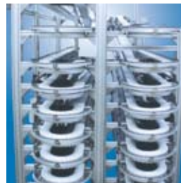
Système tampon du stockage hélicoïdal
