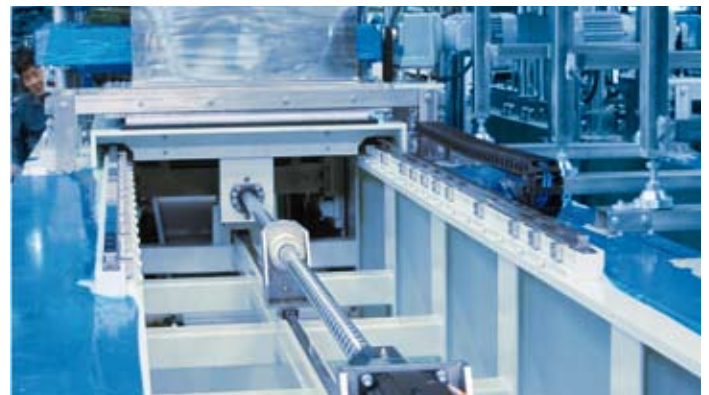
Unité à levre télescopique d'une installation de remplissage de soupes lyophilisées ; guidage à billes sur rails des deux côtés pour un processus précis et dynamique de l'unité, entraîné par une vis à billes de précision centrée
