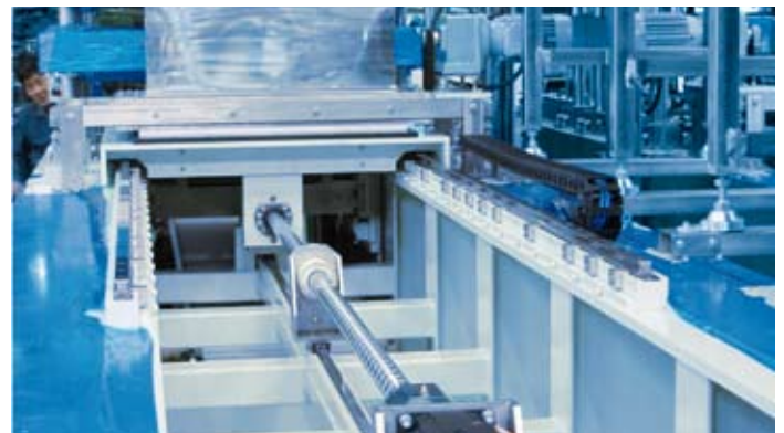
Unidad de avance de una instalación de envasado de sopa en polvo; patines de bolas sobre raíles en ambos lados para un desplazamiento de la unidad preciso y muy dinámico; accionamiento mediante husillo de precisión central
