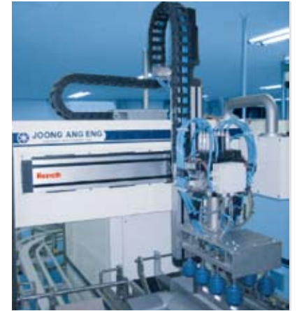
El módulo camoLINE: construcción rápida y sencilla de un sistema de manipulación específico de la aplicación
