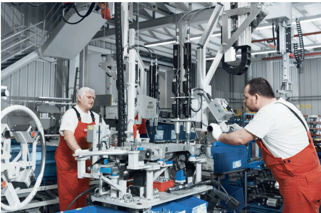
TELESKOP-BALANCER für ermüdungsfreies Arbei- ten mit handgeführten Schraubspindeln durch geringen Verschiebewider- stand
