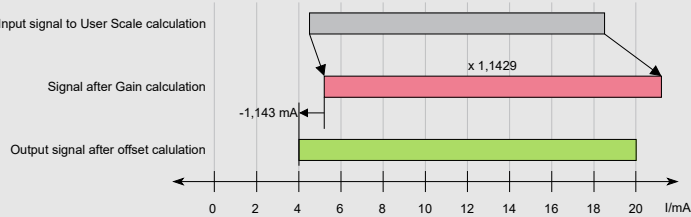
Abb. 6: Wertebereichsverschiebung von 4,5 mA bis 18,5 mA nach 4 mA bis 20 mA
