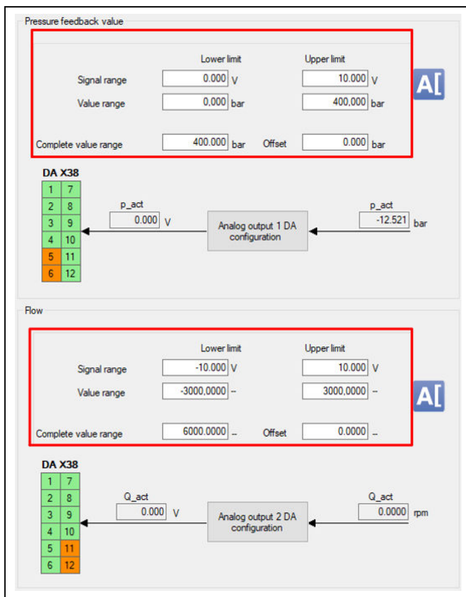
Fig. 7-37: Normalization of the actual value outputs
