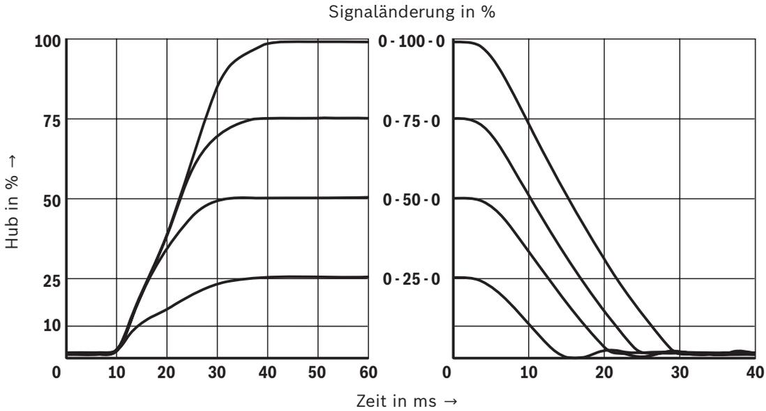
**Volumenstrom-Lastfunktion bei maximaler Ventilöffnung** (Toleranz  $\pm 10 \%$ )
