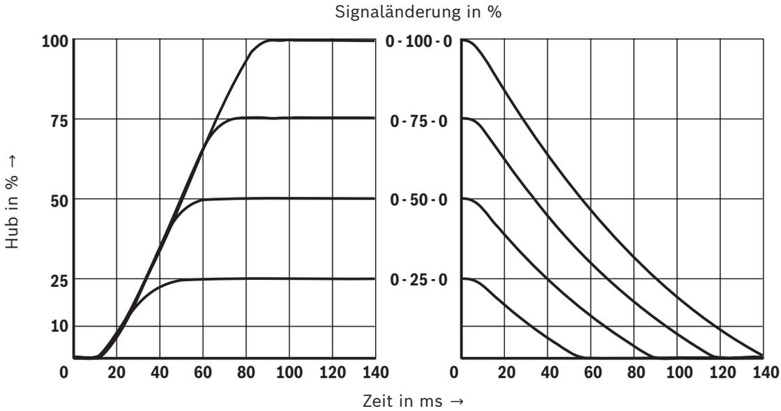
**Volumenstrom-Lastfunktion bei maximaler Ventilöffnung** (Toleranz  $\pm 10 \%$ )
