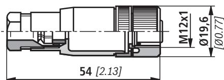
Connecteur femelle pour connecteur mâle K24 avec câble PVC surmoulé, 3 m de long
