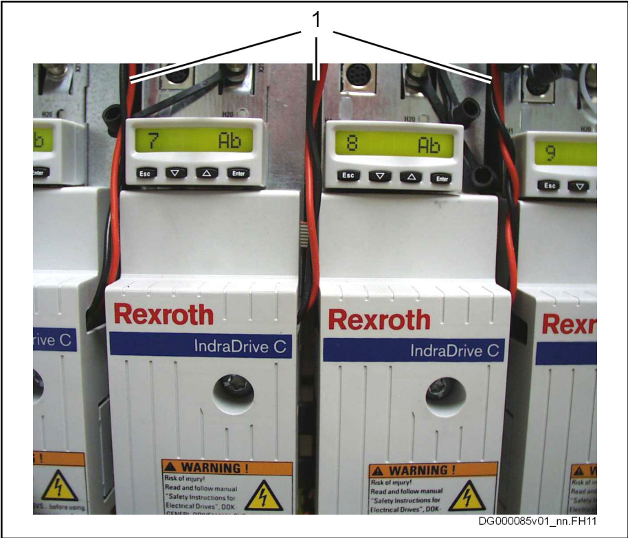
1 到控制电源的线路 插图 5-6: X13 控制电源
