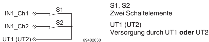
Abb. 8-16 Zweikanalige äquivalente Belegung der Eingänge, Versorgung durch UT1 (oder UT2) Querschlossüberwachung ausgeschaltet
