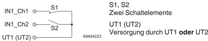
Abb. 8-25 Zweikanalige antivalente Belegung der Eingänge, Versorgung durch UT1 (oder UT2), Querschchlussüberwachung ausgeschaltet
