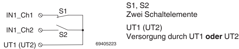
Abb. 8-40 Zweikanalige antivalente Belegung der Eingänge, Versorgung durch UT1 oder UT2 (getaktet)
