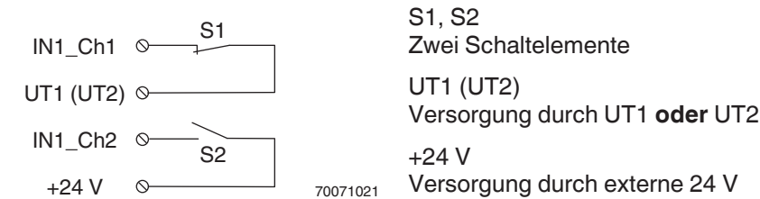
Abb. 8-37 Zweikanalige antivalente Belegung der Eingänge, Versorgung intern durch eine Taktausgang (getaktet) und extern
