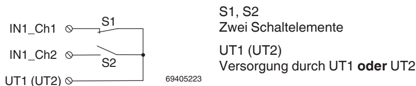
Abb. 8-42 Zweikanalige antivalente Belegung der Eingänge, Versorgung durch UT1 (oder UT2) (Taktung ausgeschaltet)
