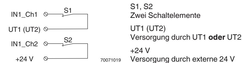
Abb. 8-19 Zweikanalige äquivalente Belegung der Eingänge, Versorgung durch UT1 (oder UT2) und extern
