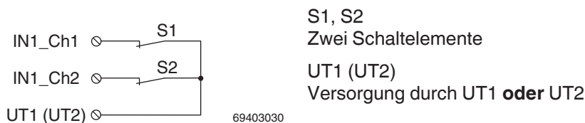
Abb. 8-22 Zweikanalige äquivalente Belegung der Eingänge, Versorgung durch UT1 (oder UT2) (getaktet)
