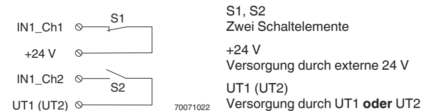
Abb. 8-38 Zweikanalige antivalente Belegung der Eingänge, Versorgung intern durch eine Taktausgang (getaktet) und extern
