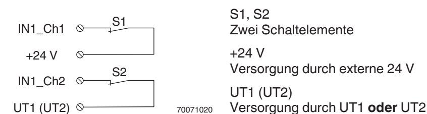
Abb. 8-20 Zweikanalige äquivalente Belegung der Eingänge, Versorgung durch UT1 (oder UT2) und extern
