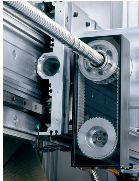
▲ Elektromechanischer Vorschubantrieb mit stillstehender Gewindespindel und über Zahnriemen angetriebener Mutter.
