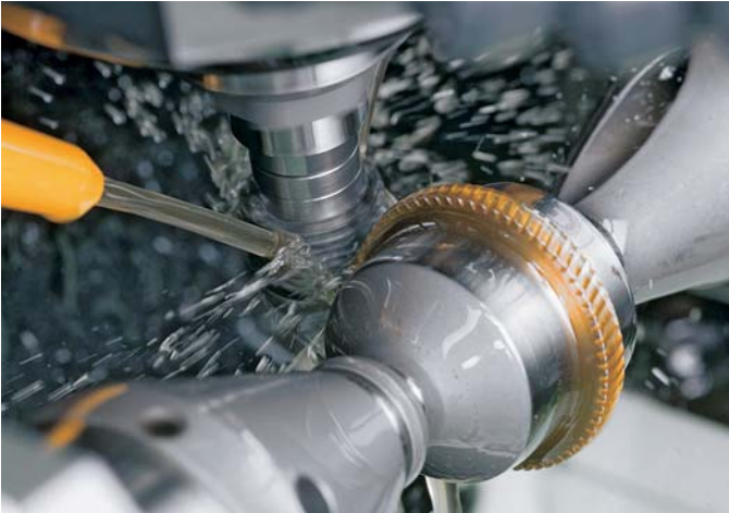
◀ Die W100 erreicht Fertigungstoleranzen von zwei Mikron.
