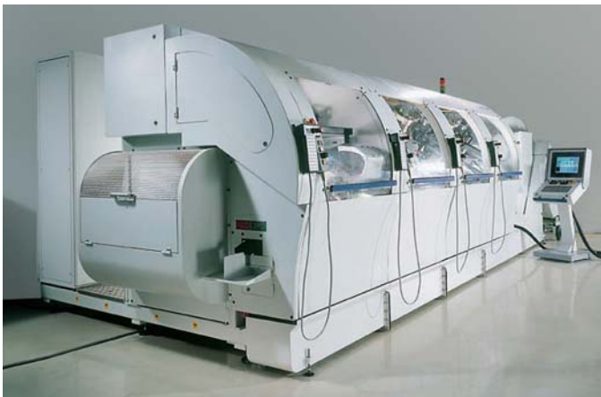
▲ Das lineare CNC Bearbeitungszentrum Mikron Multistep XS eignet sich besonders für flexible Serienläufe.
